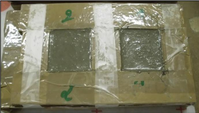
Mesures thermiques et hygroscopiques : dimensions  $44 \times 44 \times 10 \text{ mm}^3$
